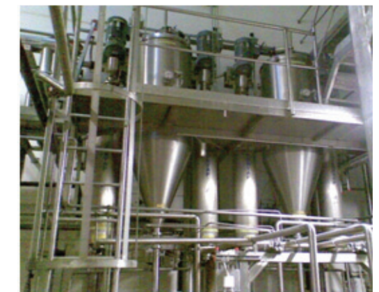
Figura 5: Evaporador 2 efeitos para produtos altamente viscosos, de cerca de 50.000 cps.
