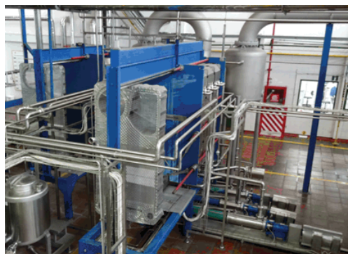
Figura 6: Evaporador de frutas preparado para um aumento de 30% na capacidade.
