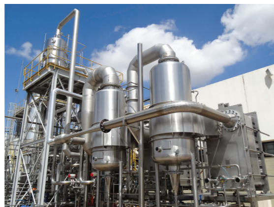
Figura 8: Evaporador para polpa de frutas tropicais.
