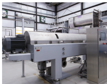
Decanter e gramole cilindriche presso lo stabilimento COR (a sinistra) e impianto di trattamento delle acque vegetali BlueVap presso il Santa Tea (a destra)
