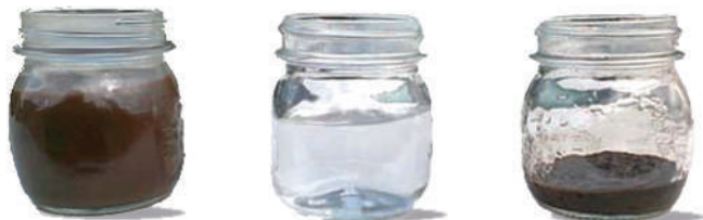
Separazione di acque vegetali (a sinistra) con BlueVap in acque chiare (al centro) e concentrato (a destra)
