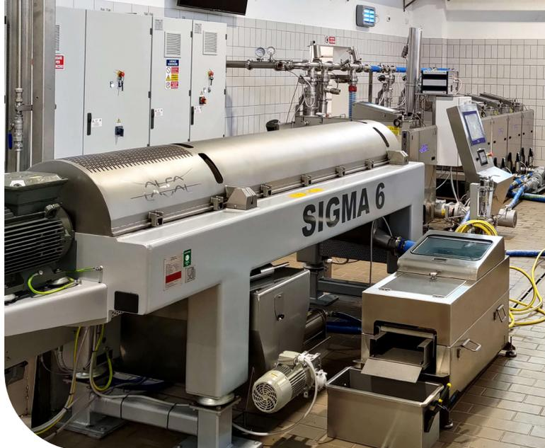
Un elemento chiave del processo è il nuovo Olive Oil Booster di Alfa Laval, che utilizza la tecnologia del vuoto per preparare delicatamente la pasta di olive frantumata e termocondizionata, riscaldandola e agitandola a pressione negativa fin quando non è pronta per il processo di estrazione con il decanter.
