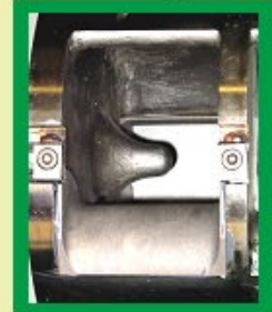
Verschleisschutz Einlaufzone Stellite oder Wolframkarbid- Platten (Austauschbar)
