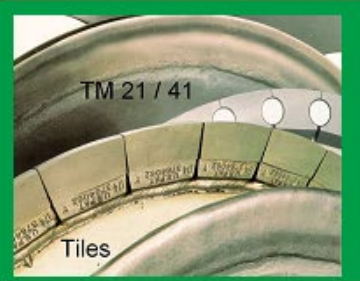
Schneckenpanzerung Wolframkarbid -Legierung Wolframkarbid-Segmente (Austauschbar)
