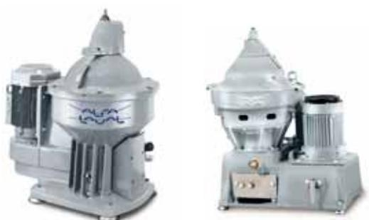
В сепараторах типа S используется технология Alcar, что позволяет применять их для очистки тяжелого топлива и остаточных нефтепродуктов с высокой и переменной плотностью. Измеряя содержание воды на выходе очищенных нефтепродуктов, система управления автоматически регулирует положение границы раздела сред нефтепродукт/вода внутри барабана.
