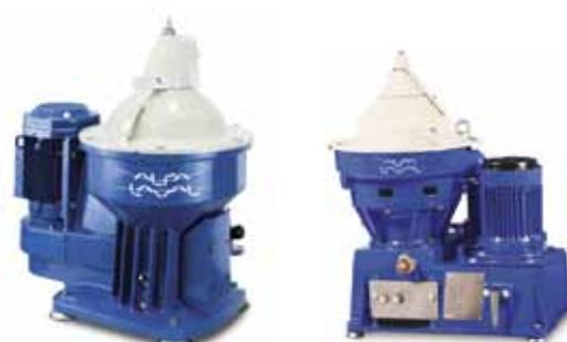
Сепараторы типа P предназначены для работы с однородными нефтепродуктами более низкой плотности, например смазочными маслами и легкими сортами топлив для судовых дизелей. В данной системе используется технология пурификации, в которой настройка процесса сепарации осуществляется подбором гравитационного диска. Данная технология не может обеспечить автоматическую компенсацию колебаний плотности.
