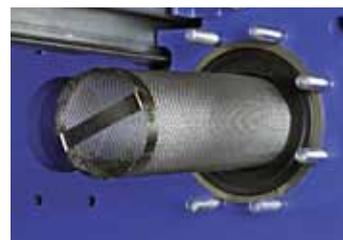
Фильтр, устанавливаемый на входе теплообменника
